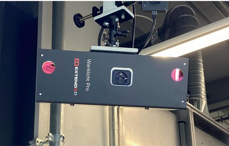
2 Eine Software steuert die Projektion und wertet Kameradaten, CAD-Daten und im Bedarfsfall Informationen anderer angeschlossener Systeme aus
